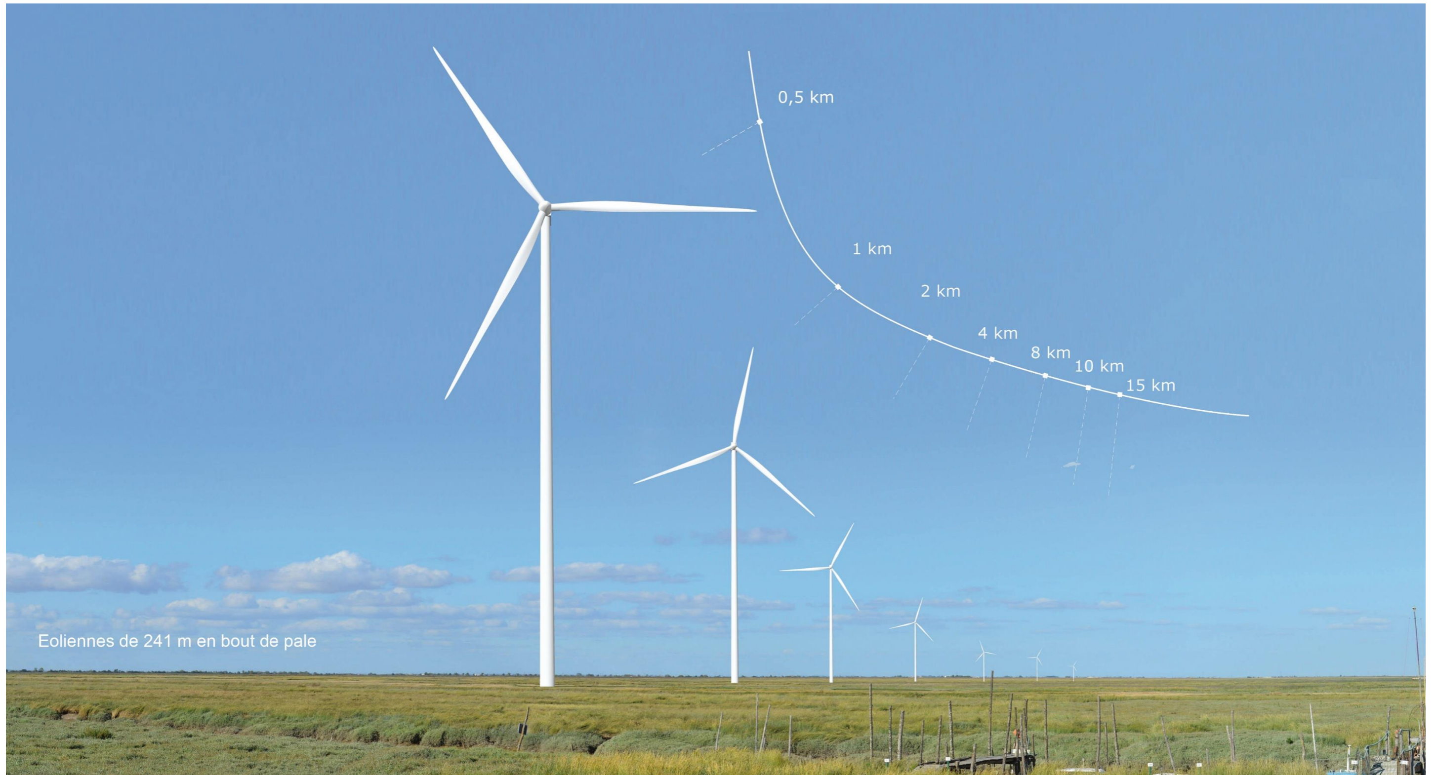
Figure 28 : Simulation en vue réaliste (angle de vue 60°) de la vision des éoliennes selon la distance de l'observateur
